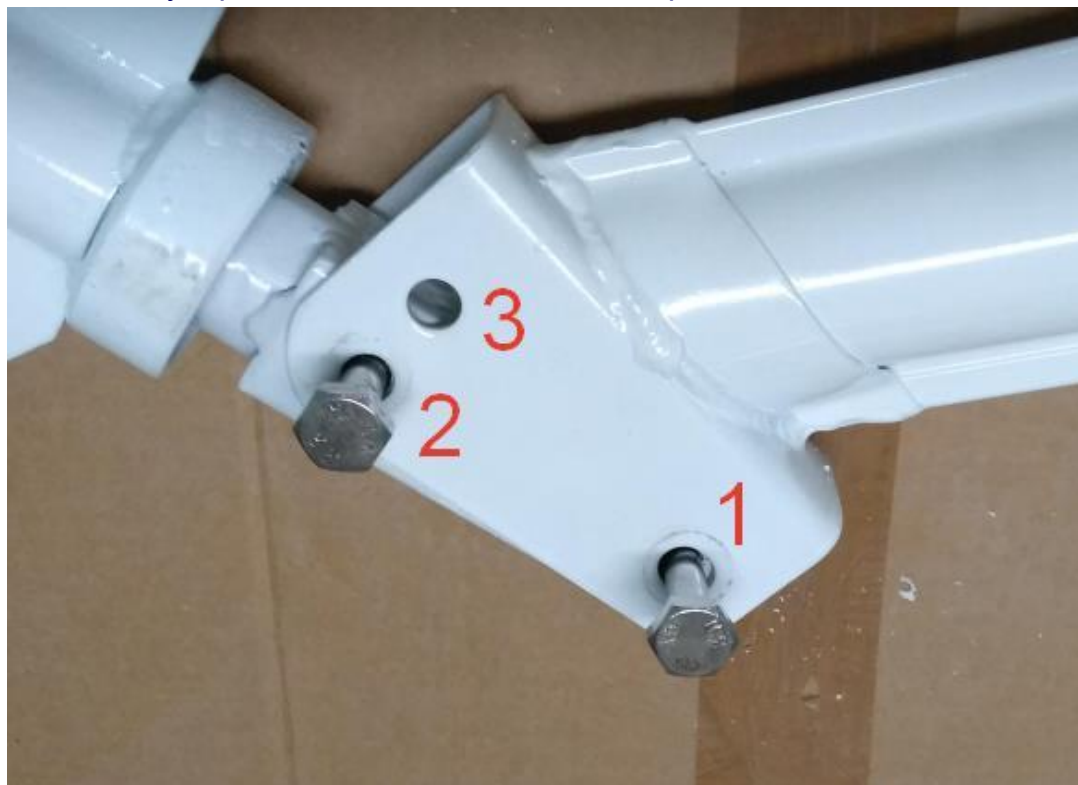
Рис. 6. Регулировка наклона хвостового оперения
